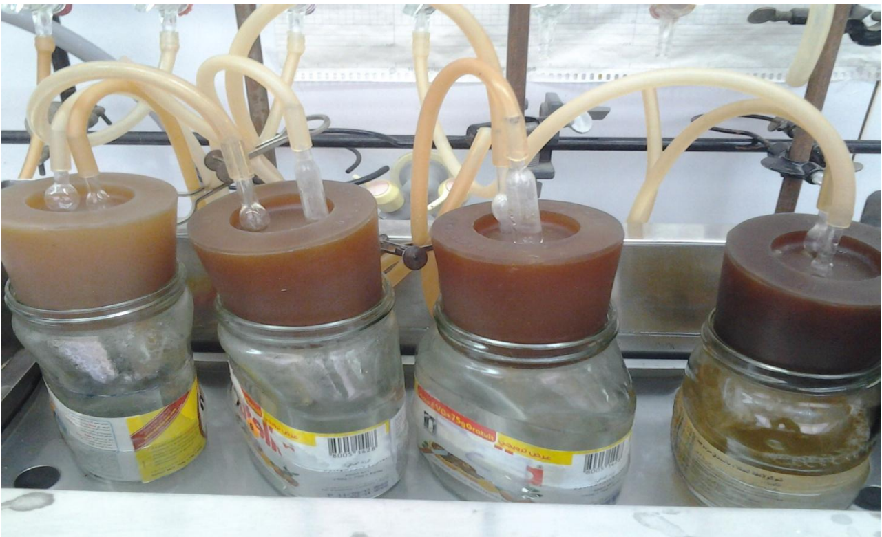
Figure n°6 : photo des seringues contenant les milieux de cultures (salive artificielle).
